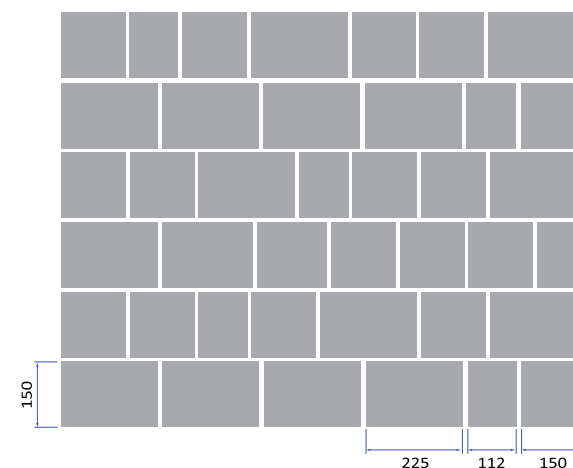
Раскладка плит в ряду
